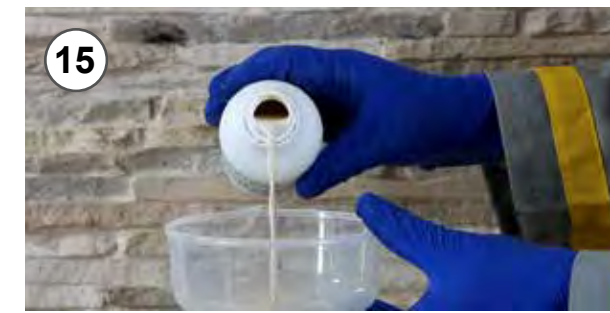
15 - Versare parte di ossido miscelato in un contenitore 15 - Pour the mixed oxide into a little container
