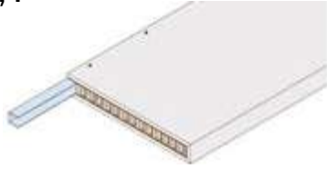
Assemblaggio su guida "U" 30x28 mm
