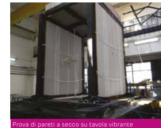
Prova di pareti a secco su tavola vibrante
