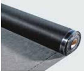
Membrana impermeabile ad elevata traspirazione ( $s_d$  **0,03 m**), 145 gr/m<sup>2</sup>, adatta per tutti i tetti a falda, per la posa sia su tavolato che su isolante. Resistente ai raggi UV.
