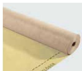
Freno al vapore ( $s_d$  **3 m**), 160 gr/m<sup>2</sup>, con elevata resistenza meccanica, da posizionare sul tavolato, sotto l'isolante. A tenuta d'aria, evita danni da condensa. Resistente ai raggi UV.
