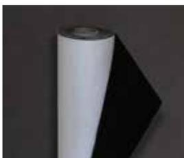
Membrana protettiva per pareti ( $s_d$  **0,035 m**), 195 gr/m<sup>2</sup>, per la protezione degli edifici con rivestimenti ventilati contro l'esposizione solare, il vento e l'umidità. Resistente ai raggi UV.
